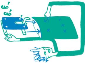
5. Assembler les barres de renfort à l'intérieur, la plaque et la baïonnette à l'extérieur de la sacoche. Fixer en même temps deux clops d'accrochage type Ortlieb.
